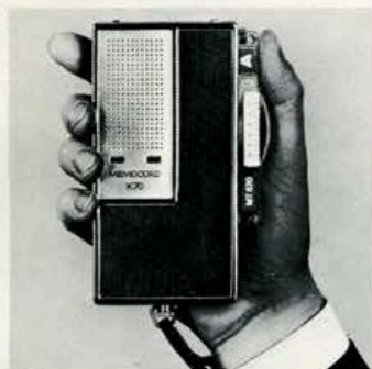
Unterwegs: Memocord K 70, vielseitiges Taschen-diktiergerät für Diktate bis zu 1½ Stunden.
